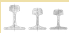
Rys. 1. Przekroje poprzeczne szyn stosowanych na PKP; od lewej: UIC 60, S 49, S 42.
