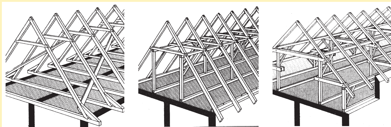
Rys. 1 Przykłady konstrukcji drewnianych więźb dachowych
