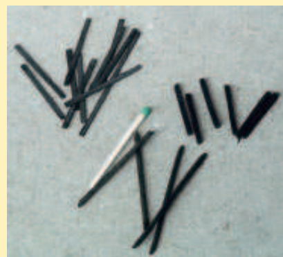
Fot. 4. Przebarwione bejcą i farbą listewki oraz paski fornirowe.
