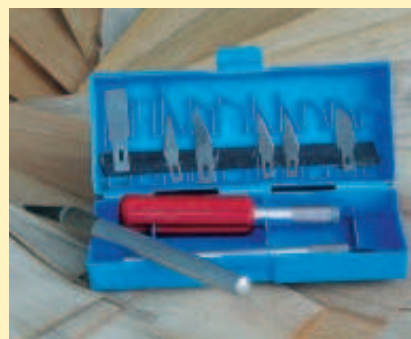
Fot. 2. Nożyki-skalpele – podstawowe narzędzia do wykonywania fornirowych desek.
